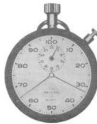
Figura 2. Cronómetro decimal de minutos de doble acción.
