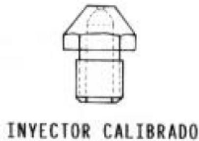
**Figura N° 4.-** Inyector calibrado.
