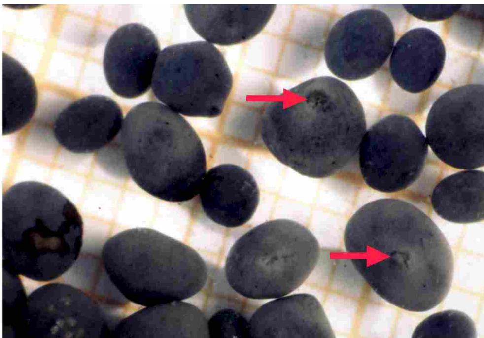
Figura 5. Gránulos de un reactor UASB que trata un efluente de un molino de reciclaje de papel (<http://www.uasb.org/discover/granules.htm#granules>).
