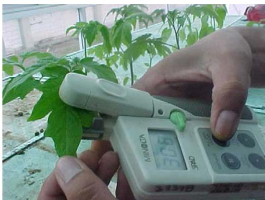
Fig.11. Medición de clorofila total, mediante SPAD.
