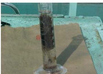
Fig. 10. Medición peso volumétrico de raíz
