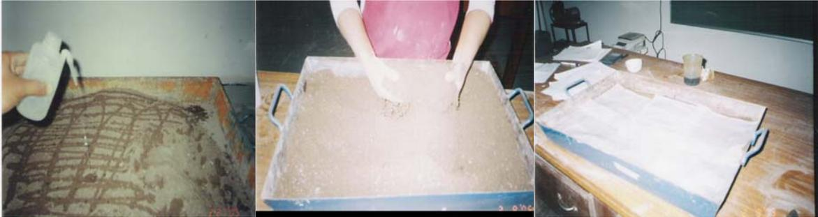
Fig. 3.6.2. Adición del agua, mezclado en húmedo y papel húmedo para evitar perder la humedad.
