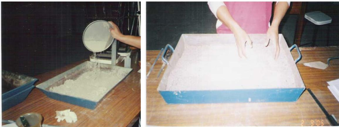
Fig. 3.6.1. Adición del % óptimo de cemento y mezclado en seco del suelo-cemento.
