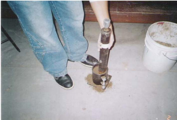
Fig. 3.6.3. Compactación de la mezcla de suelo-cemento con % óptimo de cemento y agua.
