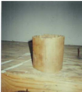
Fig. 3.6.6. Colocación de cartón húmedo sobre el espécimen de suelo-cemento.
