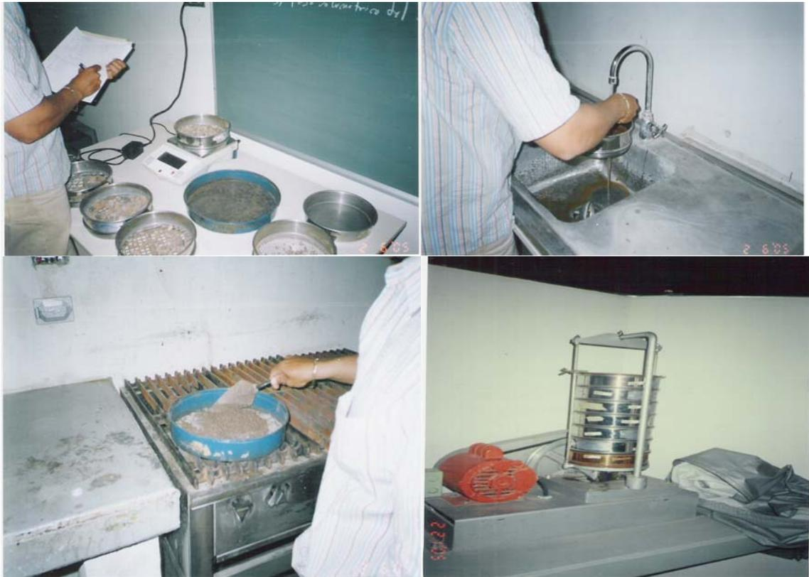
Fig. 3.5.2. Determinación Granulométrica, lavado por la malla 200, secado y agitado del material menor.
