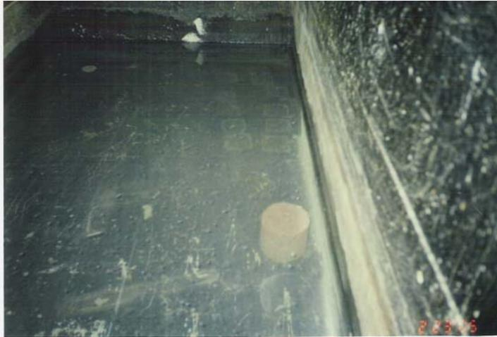
Fig. 3.6.8. Saturación por inmersión en agua durante 4 hrs. antes de ser ensayados.
