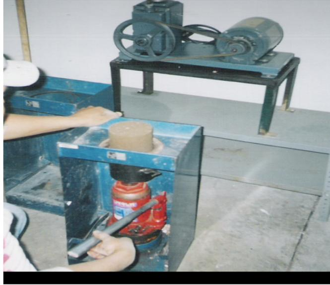
Fig. 3.6.4. Extracción del espécimen del molde de compactación mediante un gato hidráulico.
