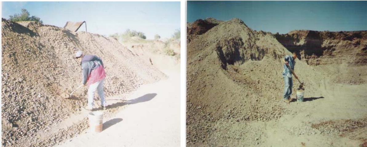
Fig. 3.3.1. Muestras integrales de material acamellonado de los banco del km 9 y km 19 respectivamente.
