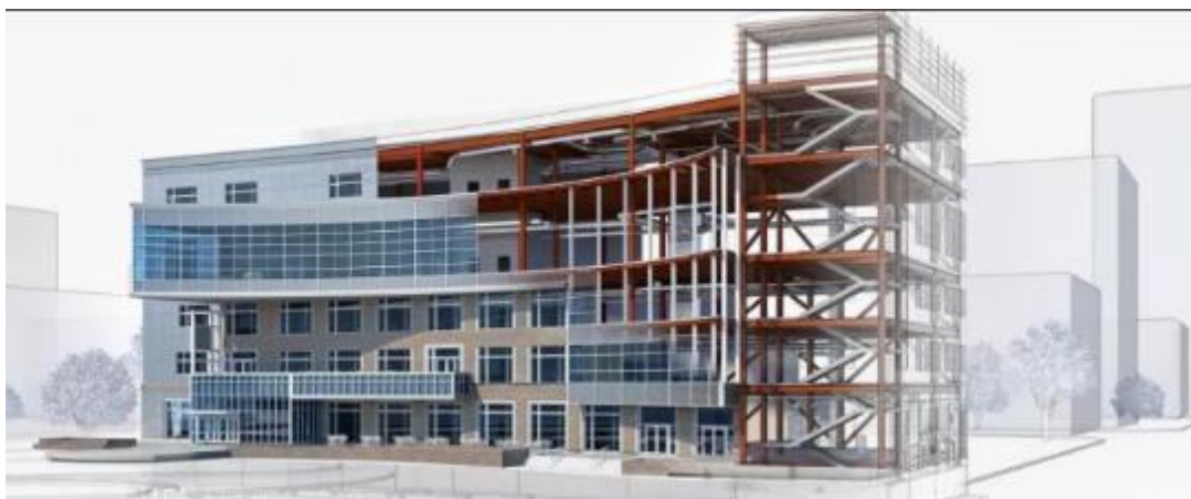
Figura 19. Modelo BIM de arquitectura y estructura.
