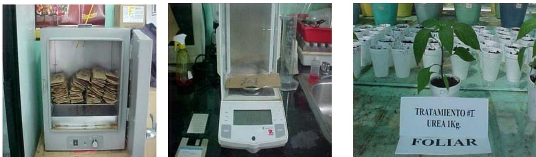
**Figura 9.** Determinación del peso seco de la parte aérea.
