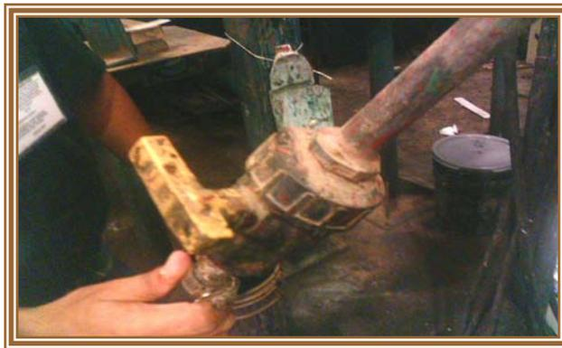
Figura 11. Mantenimiento Escaso para las Llaves de Suministro de Tinta.
