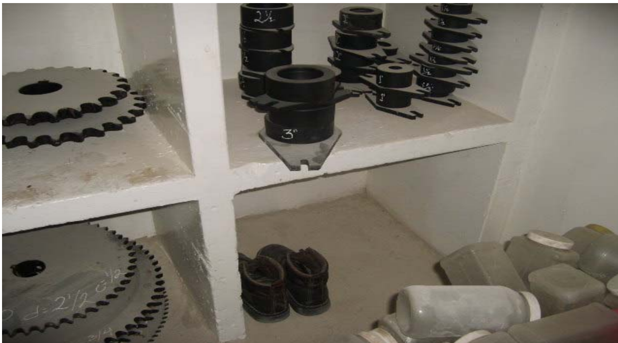
Figura 34. Material sin identificación y con Mala Utilización del Espacio.
