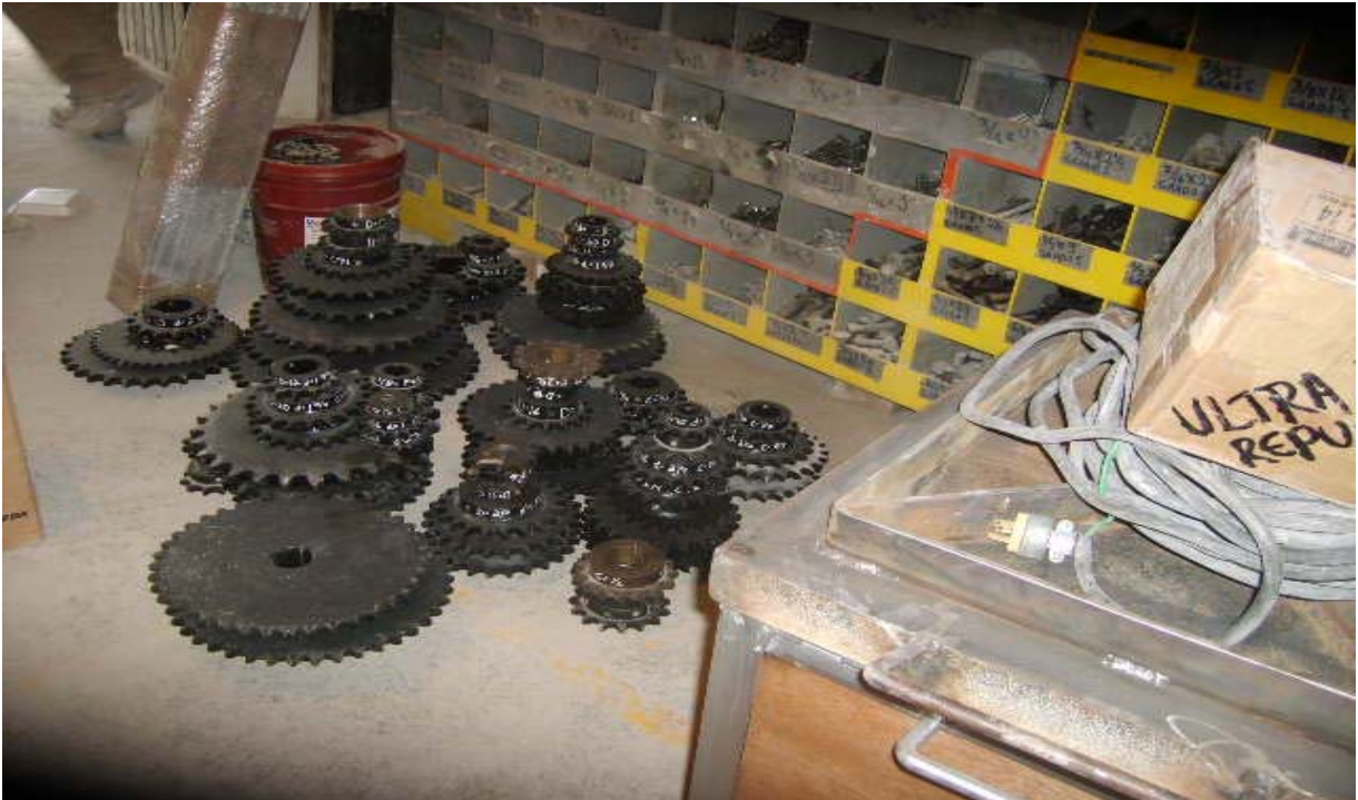
Figura 10. Forma Incorrecta del Acomodo de las Catarinas Obstruyendo el Paso.
