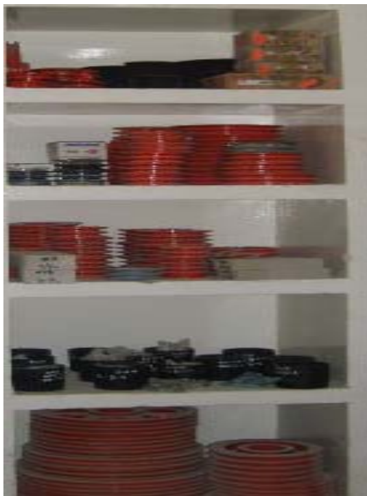
Figura 14. Forma incorrecta de las Poleas sin Identificación.
