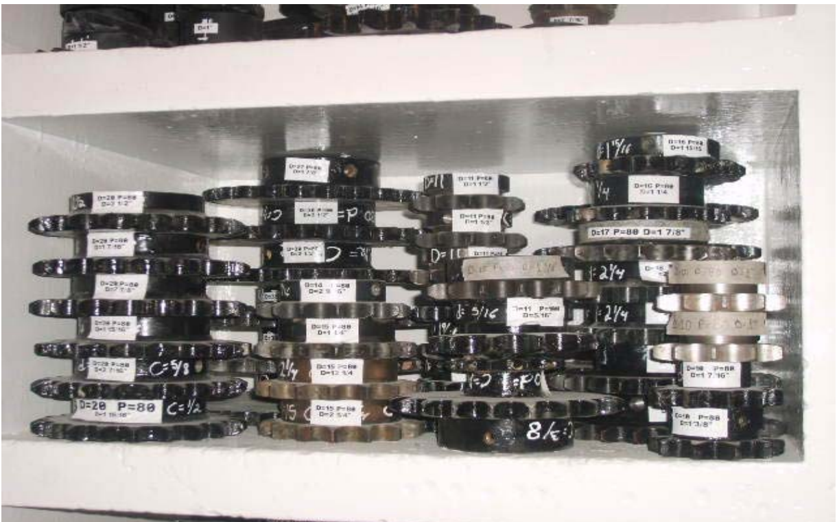
Figura 11. Forma Correcta del Acomodo de las Catarinas.
