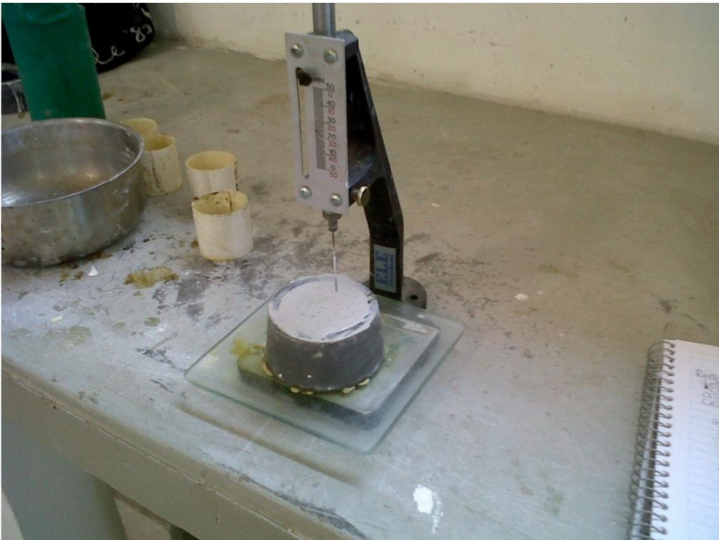
**Figura 3.3.2** Prueba de fraguado con aparato de Vicat.
