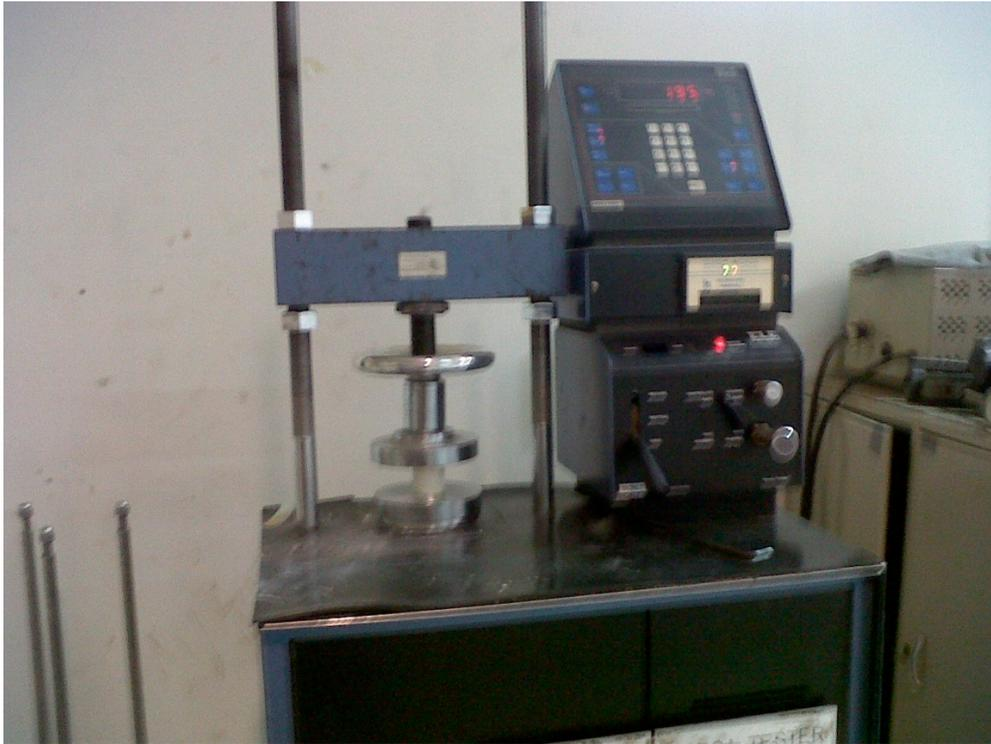
**Figura 3.3.3** Prensa universal VERSA TESTER con capacidad de 30 toneladas
