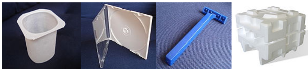
Figura 8. Aplicaciones del Poliestireno en distintos utensilios, Poliestireno choque, cristal, extruido y expandido. (14)
