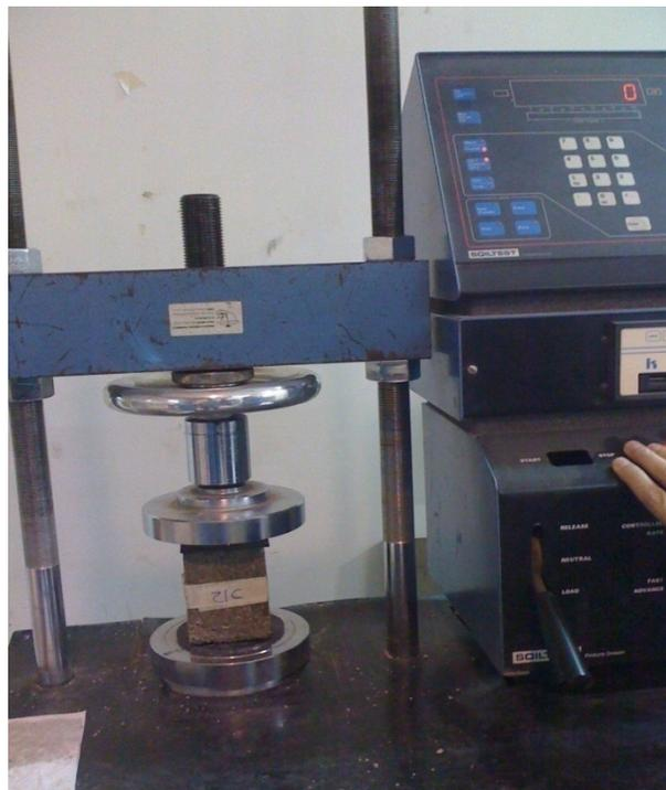
Figura 4.1 Ensaye de esfuerzo a compresión
