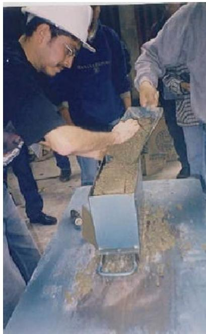
Figura 2.1 Fabricación de bloques de concreto vibrado.
