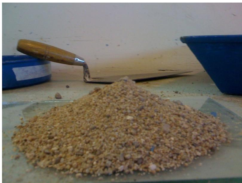
Figura 3.10 Muestra de la arena sin humedad libre después de usar el cono de absorción
