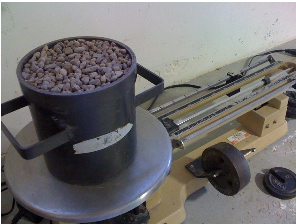
Figura 3.8 Recipiente cilíndrico utilizado para la prueba de peso volumétrico.
