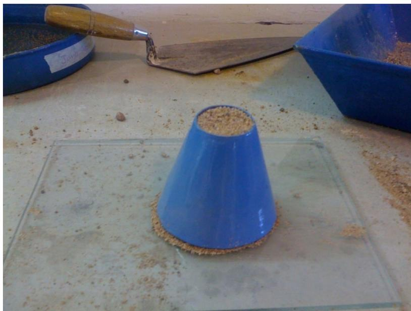
Figura 3.9 Ensayo del cono de absorción.
