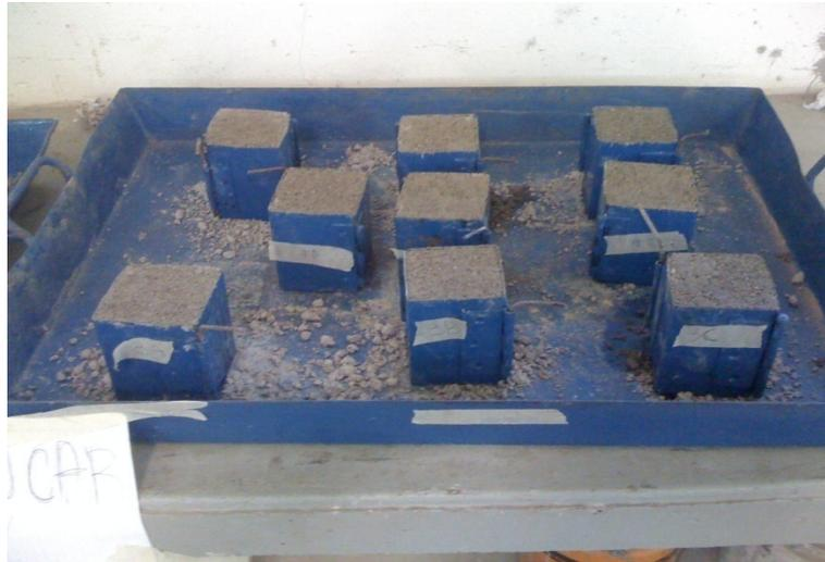
Figura 3.1 Moldes utilizados para las probetas
