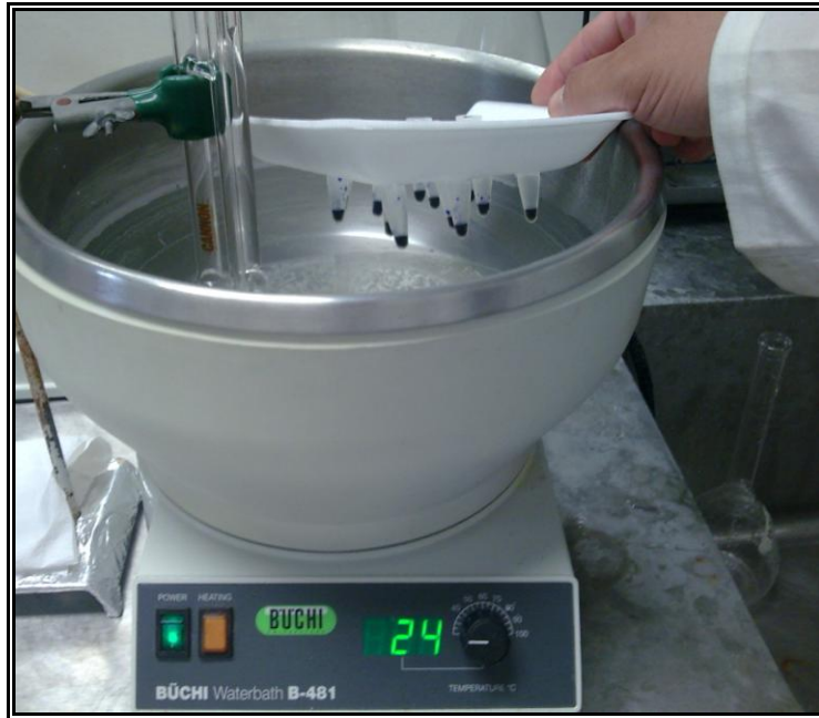
Figura 23. Desnaturalización de las proteínas para SDS-PAGE
