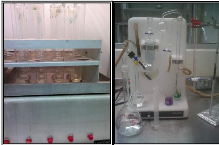
Figura 15. Cuantificación del nitrógeno total por el método Kjeldhal
