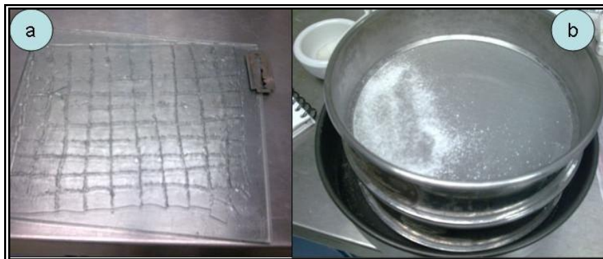
Figura 19. Preparación del empaque para columna de cromatografía: (a) gel cortado para deshidratación y (b) tamizado en malla No. 80
