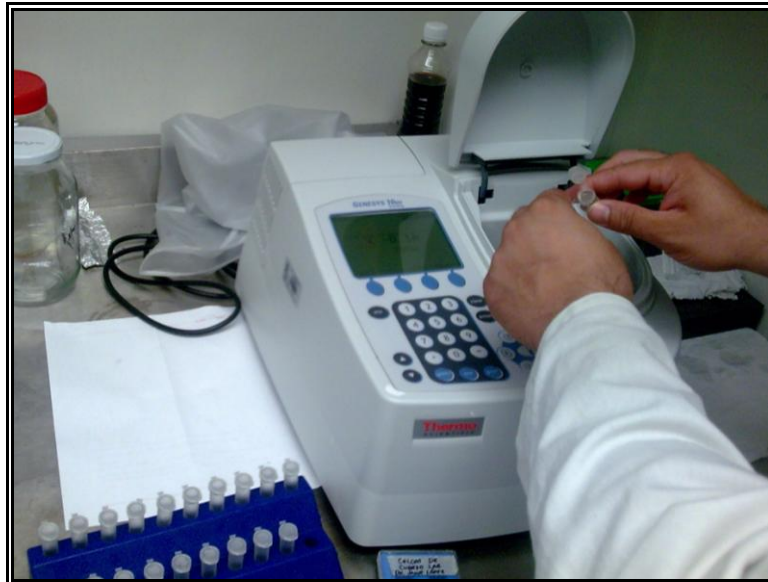
Figura 21. Espectrofotometría de absorción UV-Vis, empleada en la separación cromatográfica de proteínas y el método de Bradford
