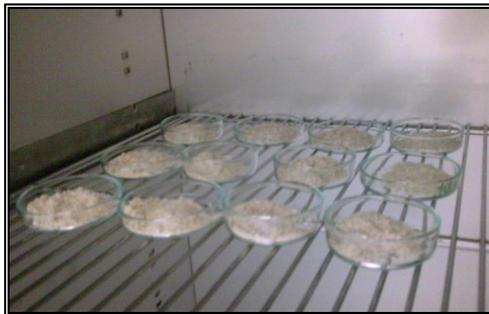
Figura 12. Determinación de humedad en SMO por secado atmosférico
