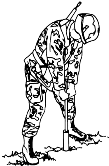
Figura II.14 Uso del penetrómetro en un suelo adecuado
