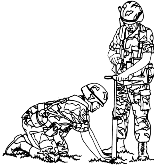
Figura II.17 Uso adecuado del penetrómetro de cono CN-973
