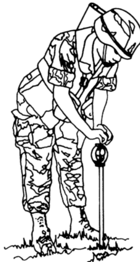
Figura II.12 Uso del penetrómetro en un suelo adecuado.
