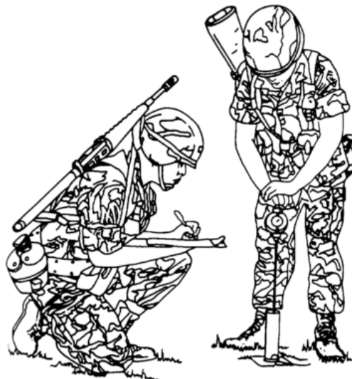
Figura II.16 Uso adecuado del penetrómetro de cono CN-973
