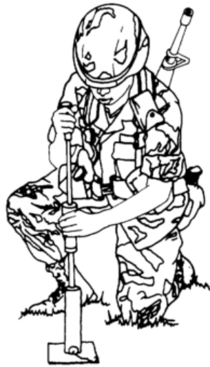
Figura II.13 Uso del penetrómetro en un suelo adecuado.
