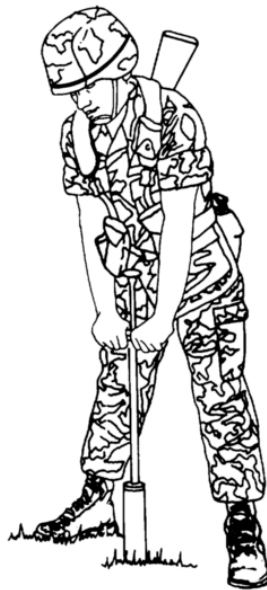
Figura II.15 Uso adecuado del penetrómetro de cono CN-973
