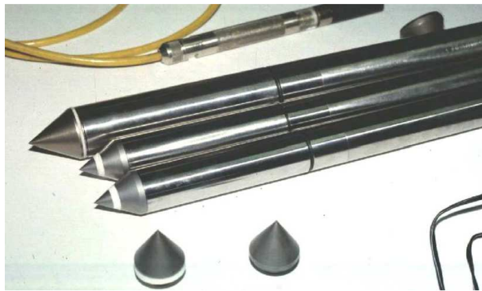
Figura I.1 Penetrómetro de cono (CPT) de empuje hidráulico y de medición continua de esfuerzos para realización de trabajos in situ.
