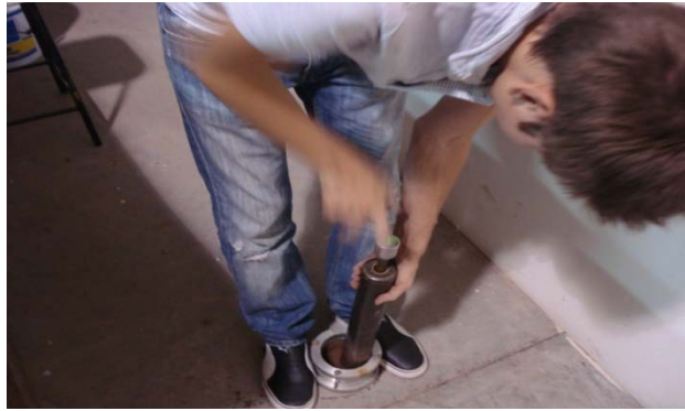
Figura III.16. Compactación del suelo dentro del molde.
