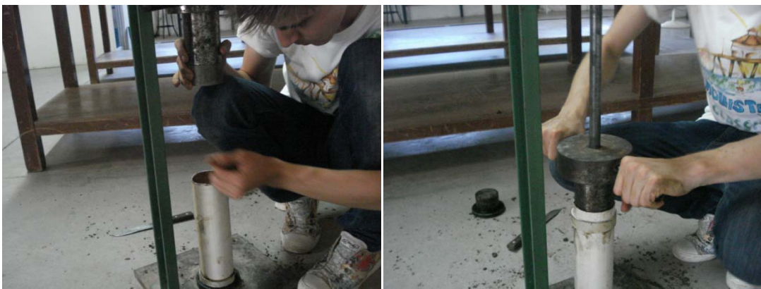
Figura III.20. Colocación del suelo en el molde y compactación del mismo en su interior.
