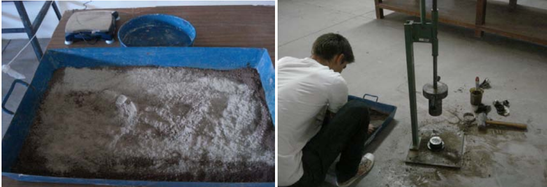
Figura III.19. Adición de cemento al suelo y preparación del equipo para la prueba.
