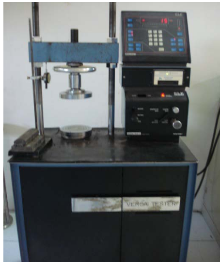
Figura III.21. Máquina para la prueba de Compresión Simple.
