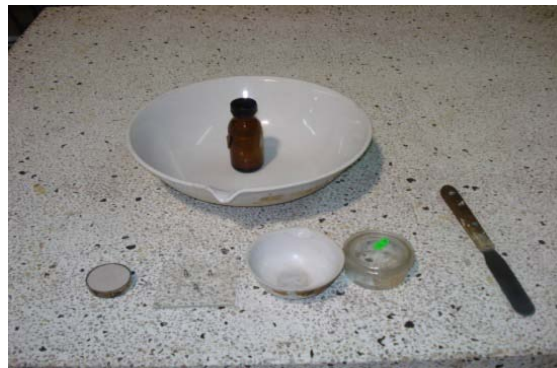
Figura III.10. Equipo para la prueba de Límite de Contracción Volumétrica.
