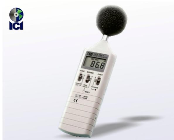
Figura 1. Sonómetro tipo II
