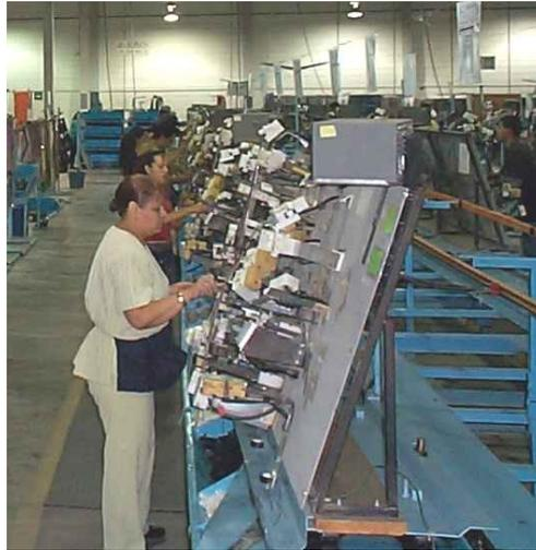
**Figura 3.** Operadores ensablado arneses en la línea de producción.
