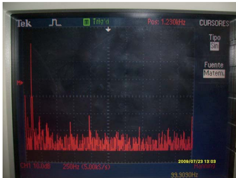
Figura 4.10. Espectro de frecuencias de la señal sinusoidal de 100Hz generada por el DDS AD9833.
