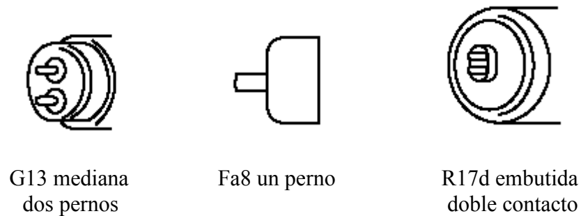
FIGURA 2.6 Tipos de bases más comunes para tubos fluorescentes
