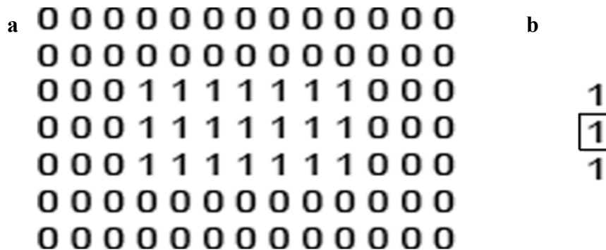
Figura 2.16 Izquierda imagen original (a). Derecha elemento de erosión (b).
