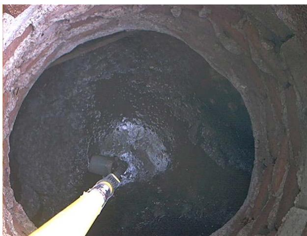
Figura 4. Toma de muestra del agua residual.
