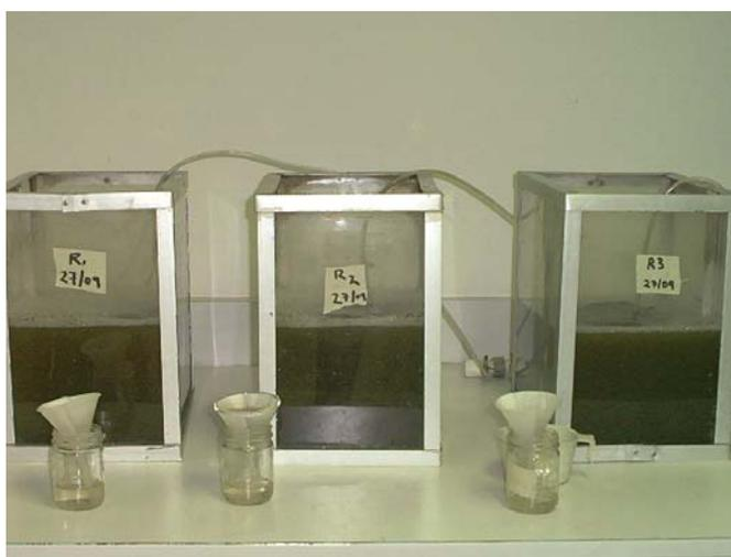
Figura 6. Reactores utilizados en las prueba de tratabilidad.
