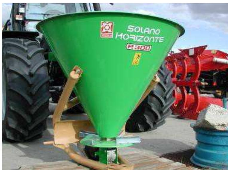
Figura 2.6. Fertilizadora Monodisco
