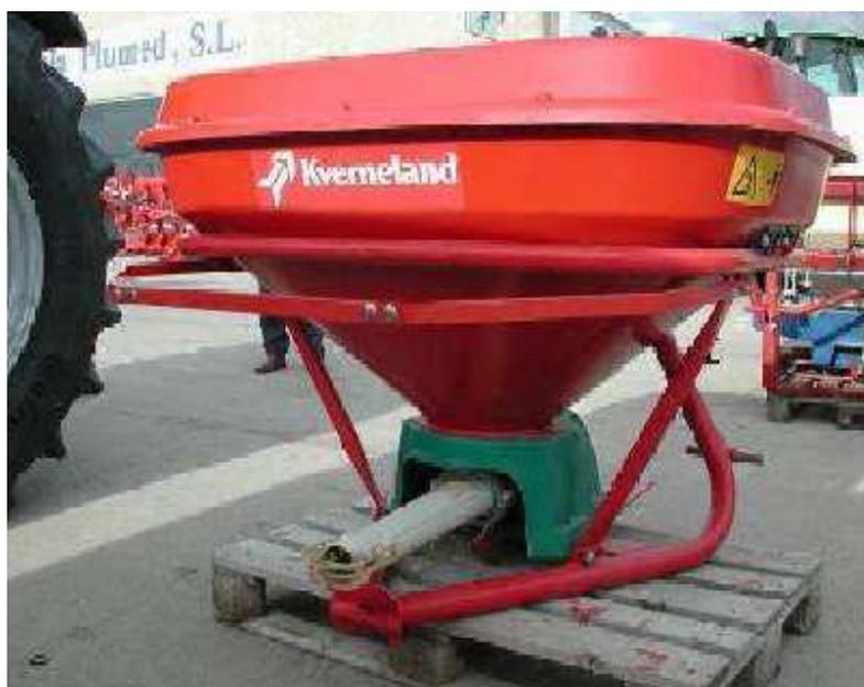
Figura 2.8. Fertilizadora Pendular
