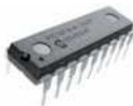
Figura 4.2. Microcontrolador PIC16F628
