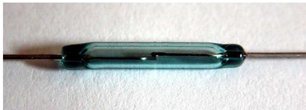
Figura 4.3. Sensor magnético reed switch
