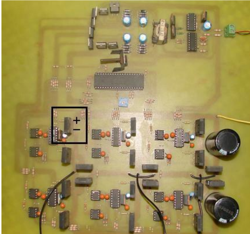
Figura 4.2. Ubicación de las terminales del disparo de compuerta a fuente en el osciloscopio.
