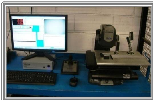
Figura 26. Equipo CNC por visión.
