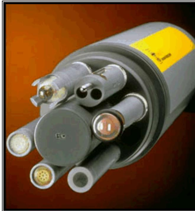
Figura 1. Muestra de los electrodos del Multisensor YSI 6820
