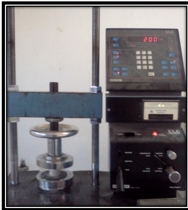
Figura 5. Ensaye de esfuerzo a compresión
