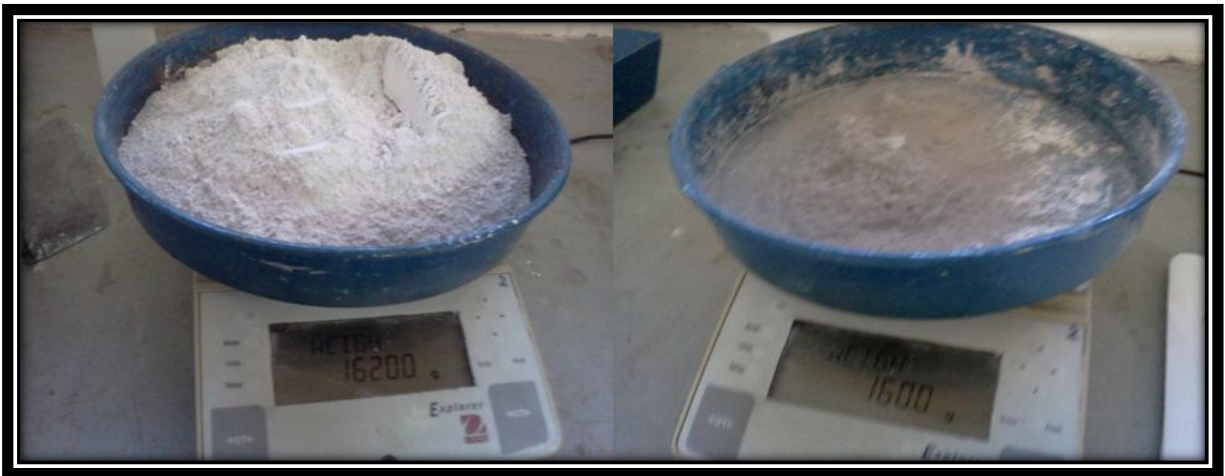
Figura 2. Peso de la Muestra de Cal y Puzolana.
