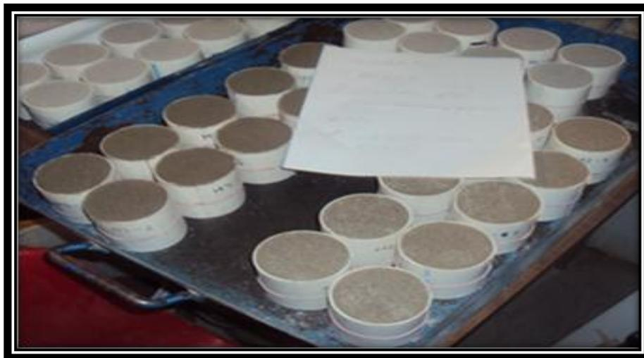
**Figura 8. Especímenes terminados en proceso de fraguado.**
