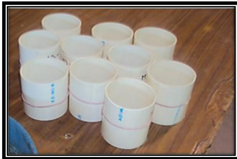
**Figura 4. Moldes cilíndricos de PVC para especímenes.**
