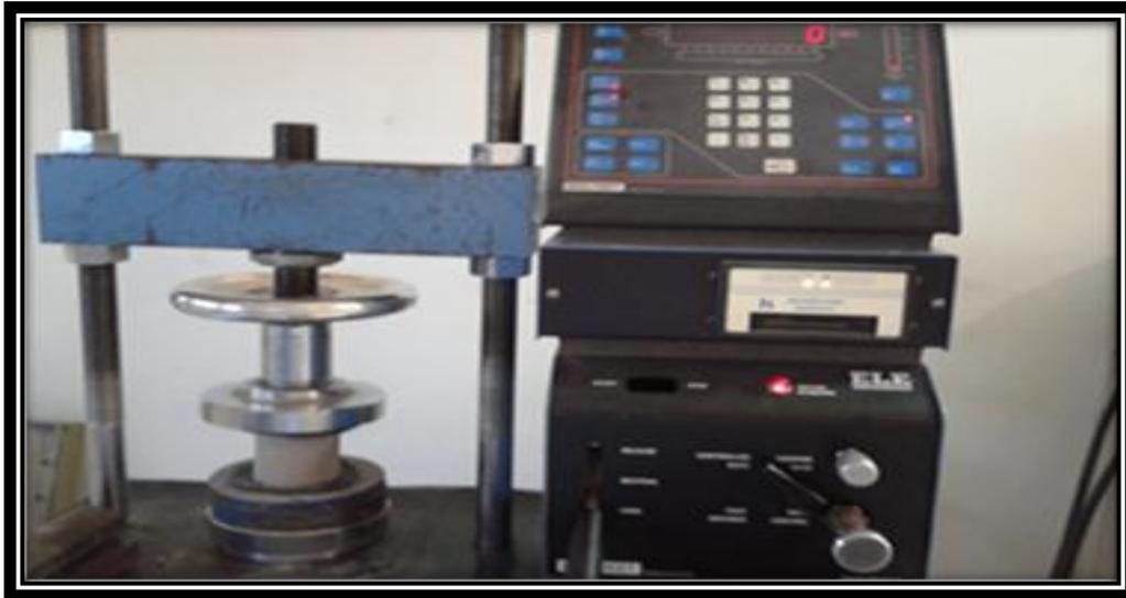
**Figura 1. Espécimen colocado a ensaye en prensa Versa-Tester.**
