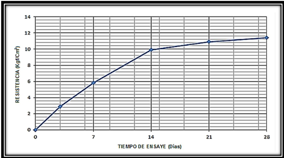
Gráfica 1 Curva de Resistencia vs Tiempo de mortero de perlita prop. 1:8.
