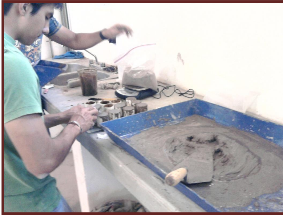
Figura 2. Colado de muestras de mortero cemento-cal.
