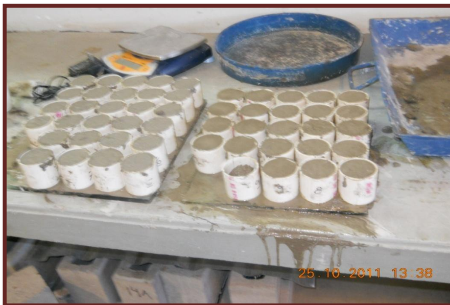
Figura 3. Muestras recién coladas, charola para preparación de mezcla y bascula para el peso de materiales.
