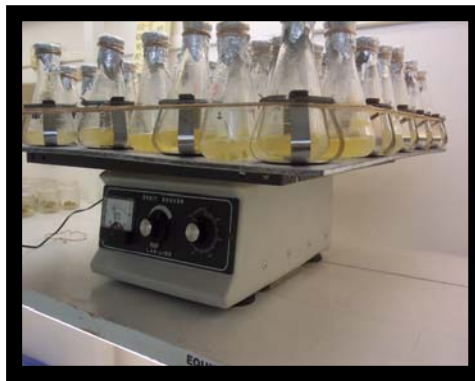
FIGURA 10. Agitador para mantener los cultivos en suspensión. ITSON 2005
