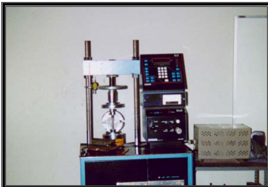
Figura 4-16. Ensaye de los especímenes en la prensa Universal.
