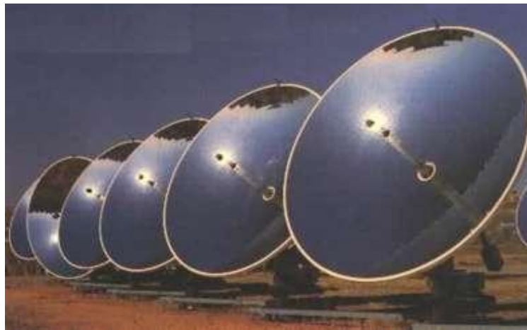
Figura 8. Colectores solares de concentración (Hernández, 2012).
