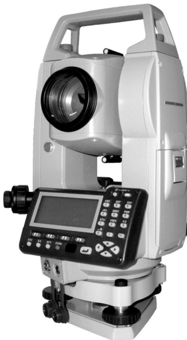
Figura 17. Instrumento de Estación Total Fuente: Beltrán y Cervantes (2010)
