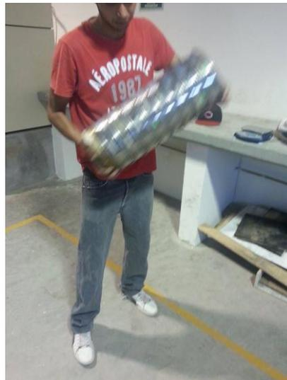
Figura 5 cribado manual del material
