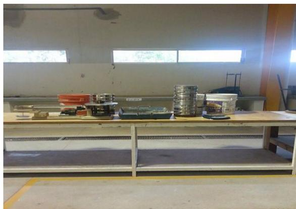
Figura 2 equipo requerido para la prueba granulométrica, tamices, bascula, charola, bascula de precisión, cucharon, cubetas.
