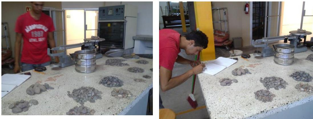
Figura 24 medición del diámetro de las partículas
