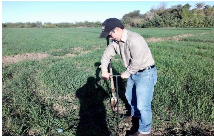
Figura 7. Muestreo de suelo con barrena.
