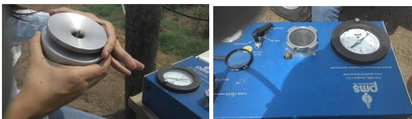
**Figura 2:** Colocación de muestra para aplicarle presión
